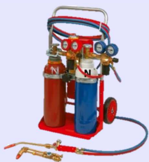
Svařovací láhve , červená je naplněná acetylenem.
