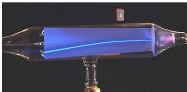
Obr. 2.2 Katodové záření uvnitř trubice se zředěným plynem, které se vychyluje účinkem magnetického pole
